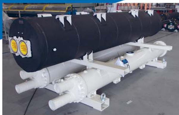
Сборка кожухотрубных теплообменников в единый блок
